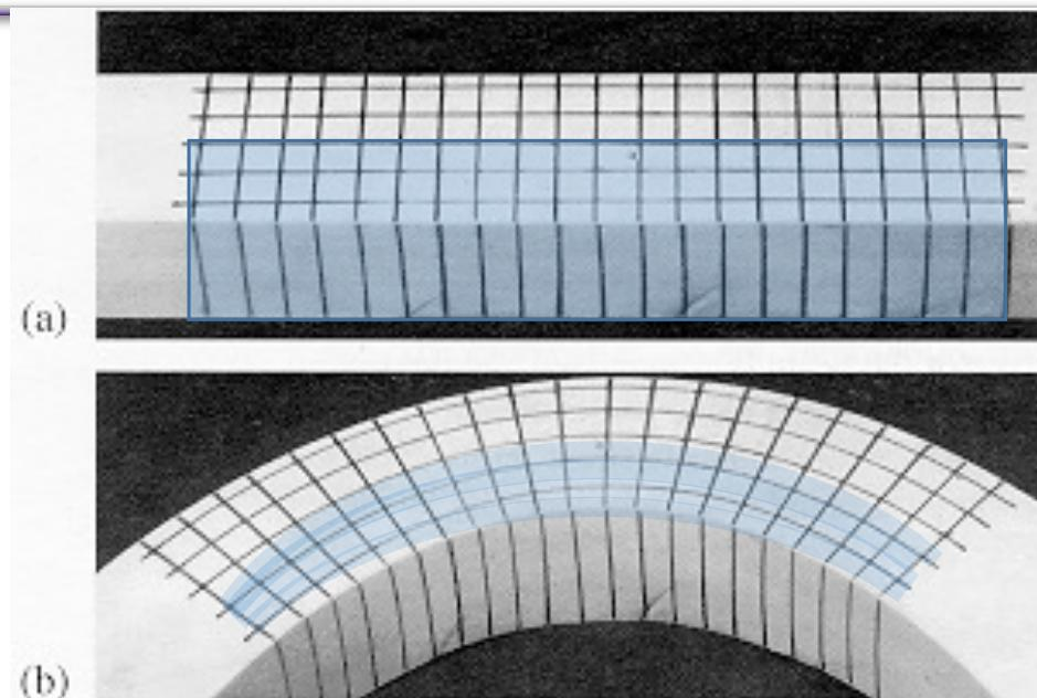
Hypothèse: les plans normaux à l'axe de la poutre avant la flexion resteront plans après fléchissement
