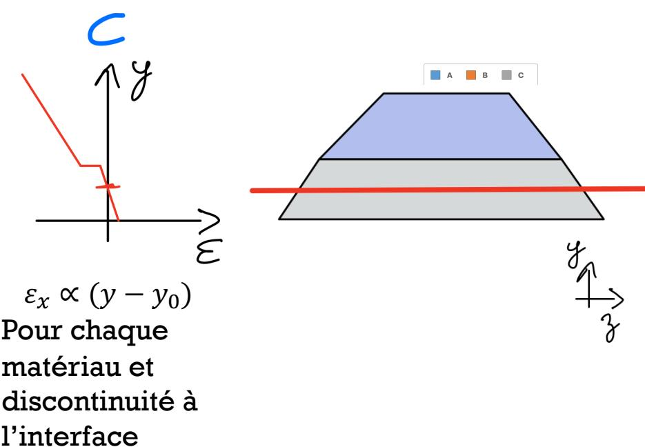
Pour une courbure donnée, la déformation de la poutre ne dépend pas de sa composition
