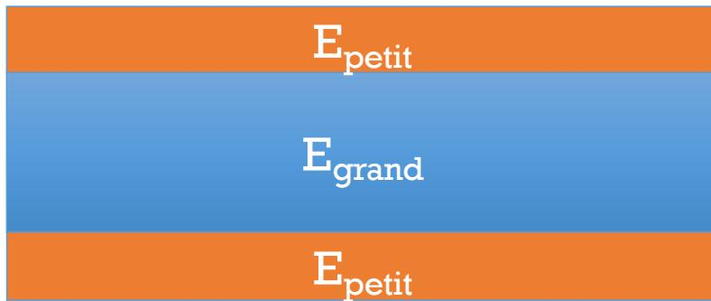
Dans ce cas, la contrainte peut être maximum aux interfaces plutôt qu'aux bords de la poutre
